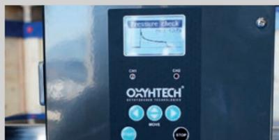
Prüfen der Bedingung des Filters / Druckregelung Differenz
